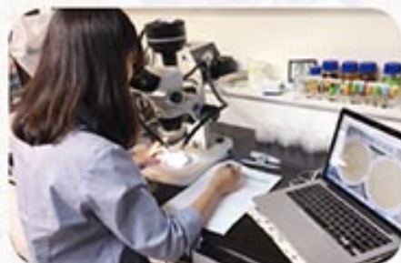
【圖6】沙灘研究濾紙檢測，研究人員需將採回的沙子用濾紙過濾並在顯微鏡下算出殘留的塑膠微粒(陳美琪 攝)
