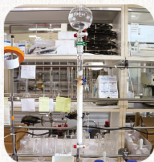
矽膠管柱層析：主要是依化合物的極性進行分離以純化天然物。
